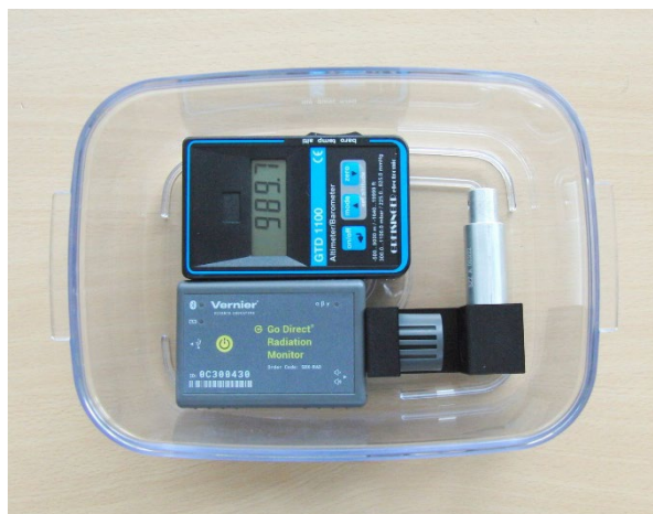
umístění čidel a zdroje ve vakuové nádobě
